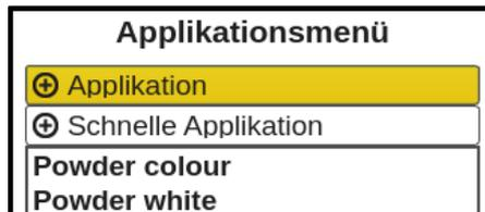
Verwenden Sie die Auf-/Ab-Pfeiltasten  $\theta$   $\pi$  ⊕, um zwischen den verschiedenen Feldern zu navigieren, und drücken Sie die OK-Taste ⊙, um das entsprechende Dropdown-Menü zu öffnen. Um eine Option im Dropdown-Menü auszuwählen, verfahren Sie auf die gleiche Weise.
