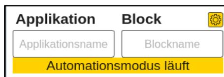
Um den Automatisierungsmodus zu stoppen, wiederholen Sie das Verfahren, indem Sie im Einstellungsmenü die Auf-/Ab-Pfeiltasten  $\theta\pi$   $\odot$  zur Auswahl verwenden und die OK-Taste  $\odot$  drücken, um zu stoppen.
