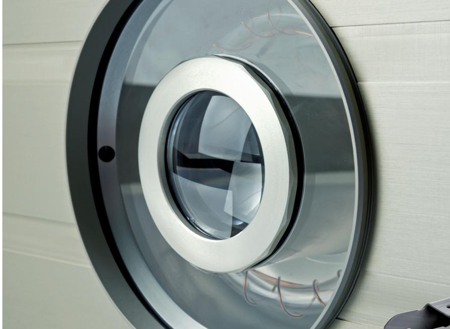
Um Lackschichten im laufenden Betrieb zu prüfen, werden diese mit einer Blitzlampe kurzzeitig erwärmt. Aus dem daraus resultierenden Temperaturverlauf können Rückschlüsse auf die Dicke und Materialeigenschaften der Beschichtung gezogen werden.
