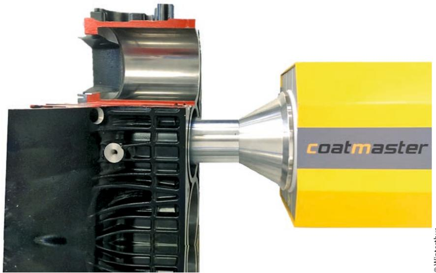
**Bild 2** > Zur Schichtdickenmessung wird die Messoptik in die Zylinderbohrung eingeführt (obere Bohrung aufgeschnitten). So kann die Schichtdicke zuverlässig an beliebigen Positionen im Umfang und in der Tiefe der Zylinderbohrung gemessen werden.
