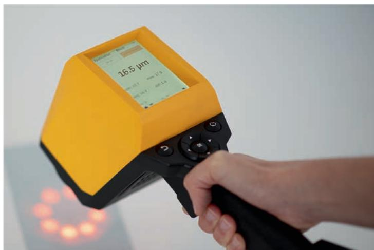
**Bild 5** > Neben den Messsystemen zur vollautomatisierten Schichtdickenmessung direkt in der Serienproduktion ist die Technologie auch in Form eines mobilen Handgeräts verfügbar.
