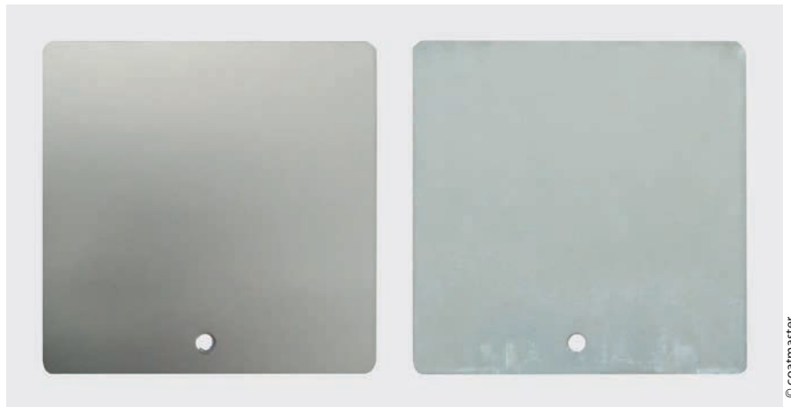
Bild 1 > Beschichtete Prüfbleche mit einer Schichtdicke von 9 µm: ohne Belastung (links) und nach 1200 Stunden in der Salzsprühnebelprüfung gemäß DIN EN ISO 9227-NSS (rechts).
