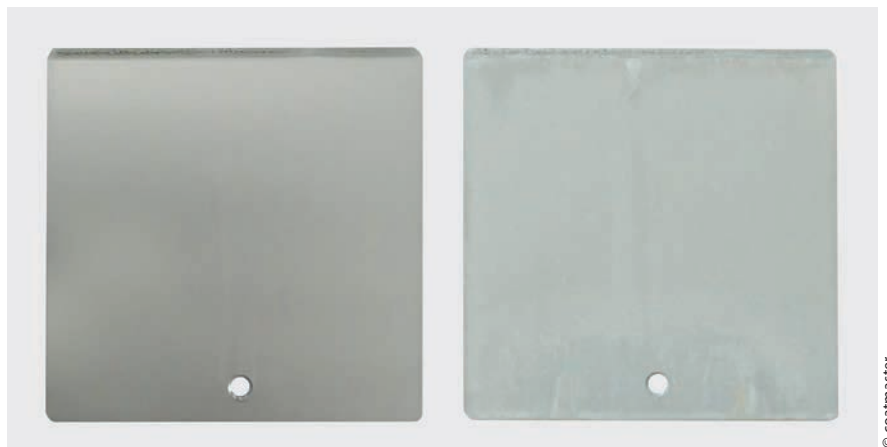
Bild 2 > Beschichtete Prüfbleche mit einer Schichtdicke von 11 µm: ohne Belastung (links) und nach 2500 Stunden in der Salzsprühnebelprüfung gemäß DIN EN ISO 9227-NSS (rechts)
