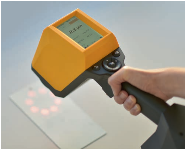
Bild 3 > Handgerät für die berührungslose Schichtdicken-Messung von nassen und trockenen Beschichtungen.
