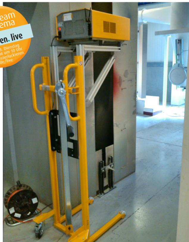
Die Messung wird automatisch durch das Signal eines Lichtschranken-Sensors ausgelöst, sobald eine Platte die Lichtschranke passiert. Quelle: Winterthur
