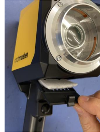
3. Untere Klappe einlegen
