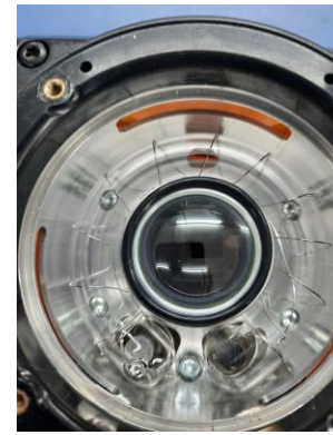
5. Neuen O-Ring einsetzen
