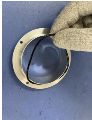
2. Alten O-Ring entfernen (Falls vorhanden)
