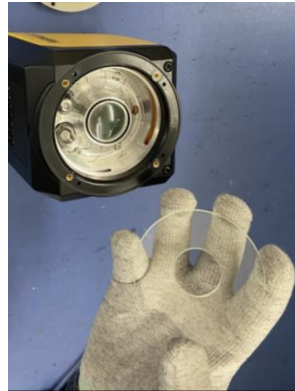
3. Alte IR-Optik entfernen
