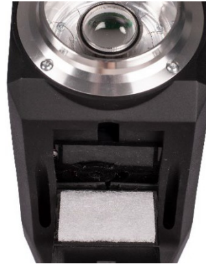
Figura 52: Substituição do filtro de entrada
