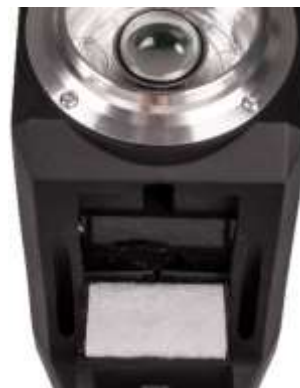
Imagen 54: Reemplazo del filtro de entrada
