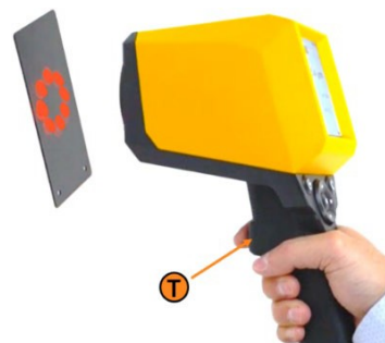
Figura 40: Misurazione di riferimento/taratura
